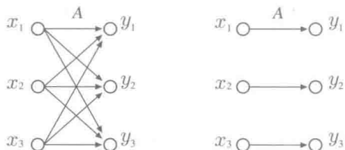
图 1.22 一般矩阵(左)和对角矩阵(右)。箭头表示哪些输入对哪些输出产生了影响
